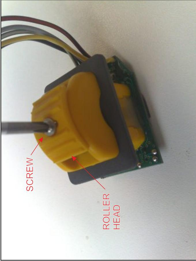
STEP 6: FIX THE ROLLER HEAD SCREWING THE SCREW
