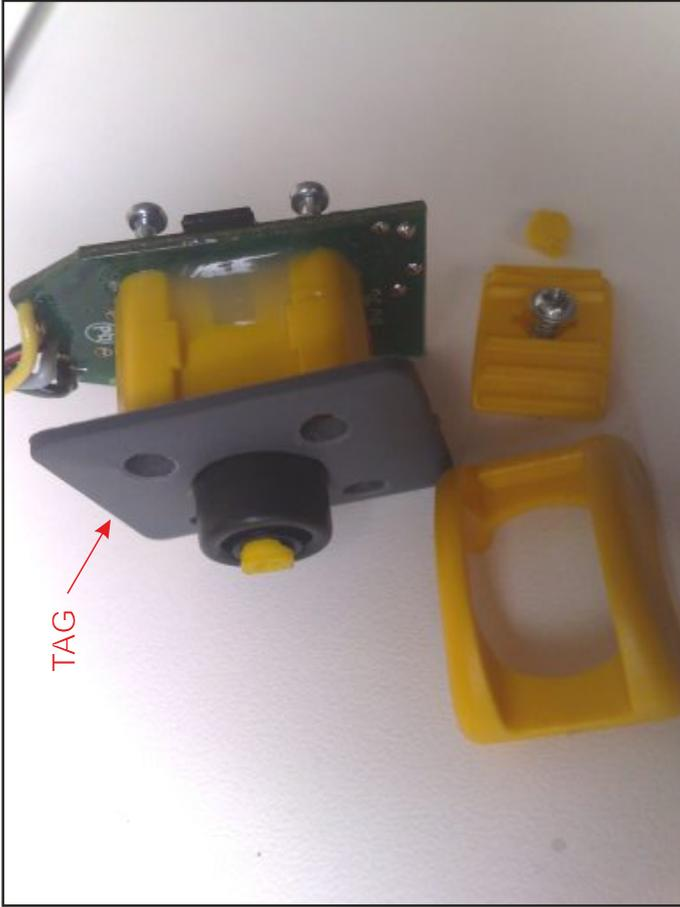
STEP 4: INSERT THE TAG TO FIX THE ROLLER ON THE TILLER HEAD
